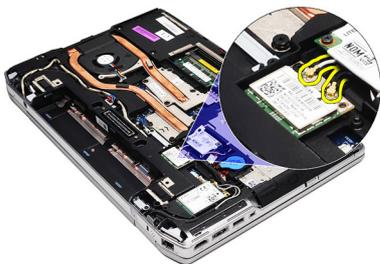
5. Remova o parafuso que prende a placa WLAN ao computador.
