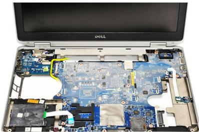
27. Levante e remova a placa do sistema para fora do computador.
