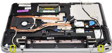
10. Levante a base do computador do conjunto da tela para soltar o cabo de LVDS e os cabos da antena do computador.
