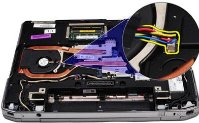
5. Remova os parafusos que prendem o conjunto do dissipador de calor à placa do sistema.
