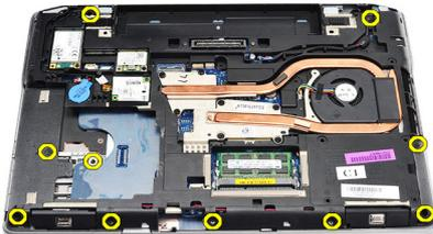
11. Vire o computador e remova os parafusos da placa do sistema.
