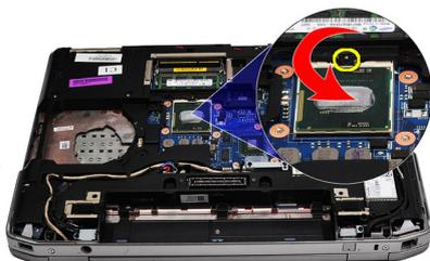
6. Levante e remova o processador da placa do sistema.
