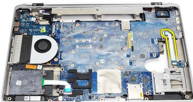
12. Remova o parafuso da placa do sistema.
