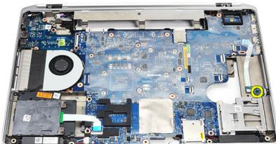
13. Remova o comutador sem fio do computador.
