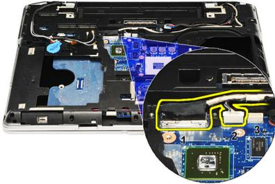
**24.** Vire o computador e desconecte os seguintes cabos da placa do sistema:
