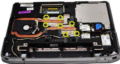
6. Levante o lado direito do dissipador de calor e deslize-o pelas laterais, removendo-o da placa do sistema.
