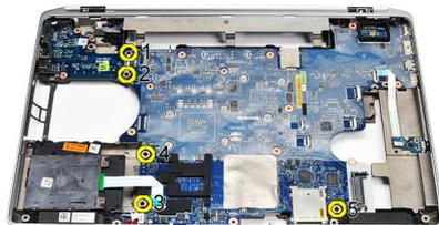
**26.** Remova a borda superior esquerda da placa do sistema do conector da placa de E/S.
