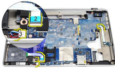
**25.** Remova os parafusos da placa do sistema.
