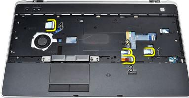
13. Levante o apoio para os pulsos em um ângulo de 45 graus e remova-o.
