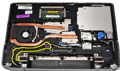
5. Remova o parafuso que prende o suporte do conector de alimentação ao computador.
